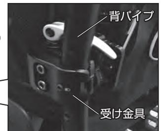
奥行き調整のネジを内側に付け替えることで、奥行きの調整がしやすくなります。
