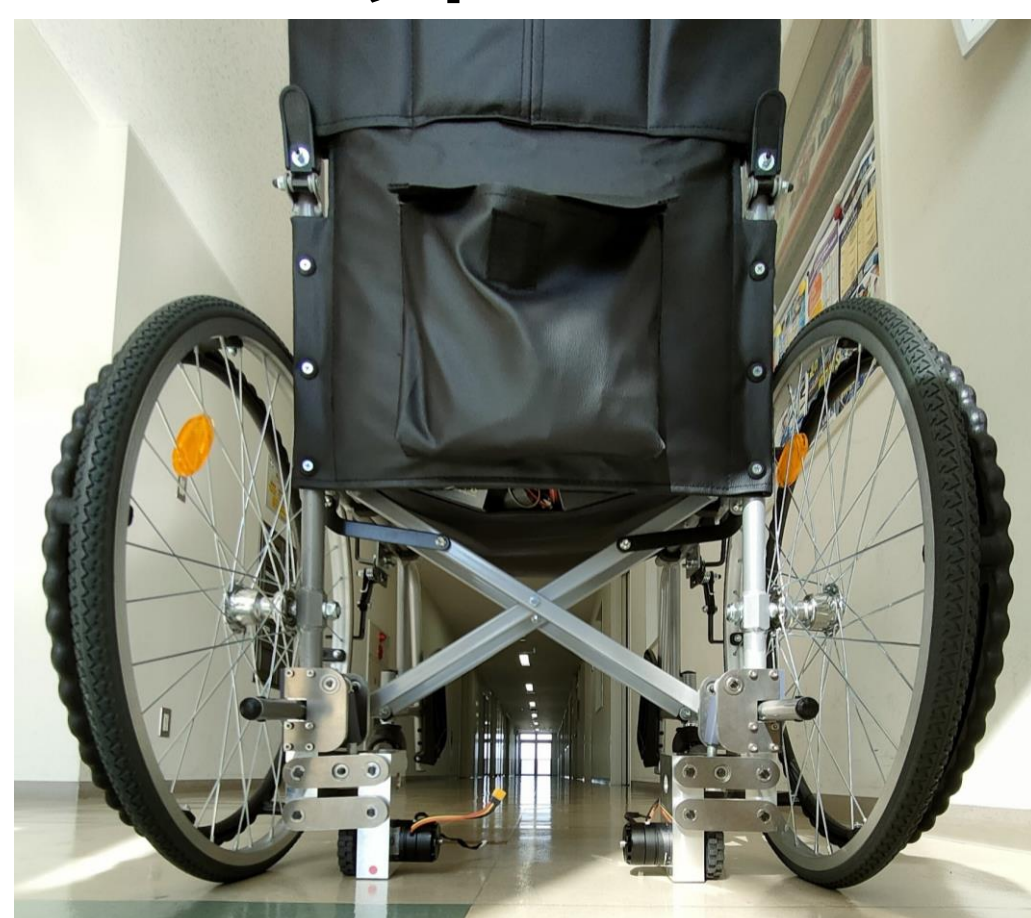
Fig.2 Attached units on a wheelchair 車いすの座席下に取り付け → コンセプト 1 の達成
