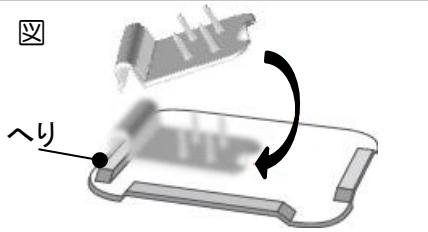
図のようにフードヘルプをへりに引っかけて本製品に固定します。へり3カ所のどこにでも取り付けることができます。
